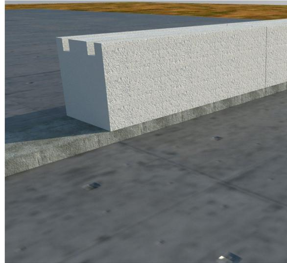
Primer Hilada sobre faja de nivelación de mortero hidrófugo.
