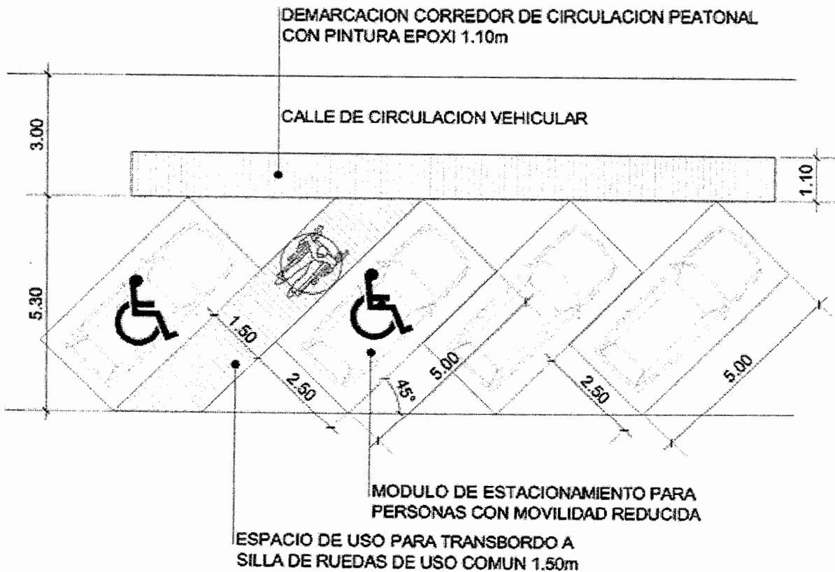
F2. Dimensiones mínimas estacionamiento a 45° para módulos exigibles
